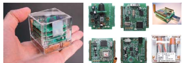
図1 無線センサネットワークテストベッド: U 3
