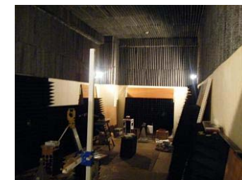
図 2 : 電波暗室による実験
